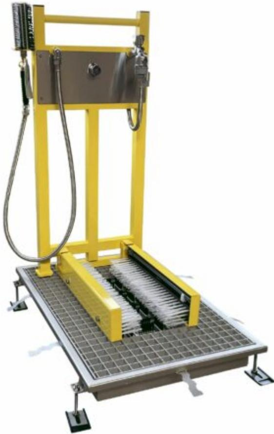
Auf dem Gitterrost der Anlage ist ein Haltebügel mit „Systemtrenner BA“ nach DIN 1717 sowie ein automatisches Wasserstoppventil angebracht. Zwei seitliche Spülrohre leiten das Wasser über die Bürsten auf das Schuhwerk. Eine wasserführende Handbürste, die in den Haltebügel der Anlage eingehängt werden kann, ermöglicht eine zusätzliche Reinigung des Stiefelschafts oder anderer Gegenstände.
