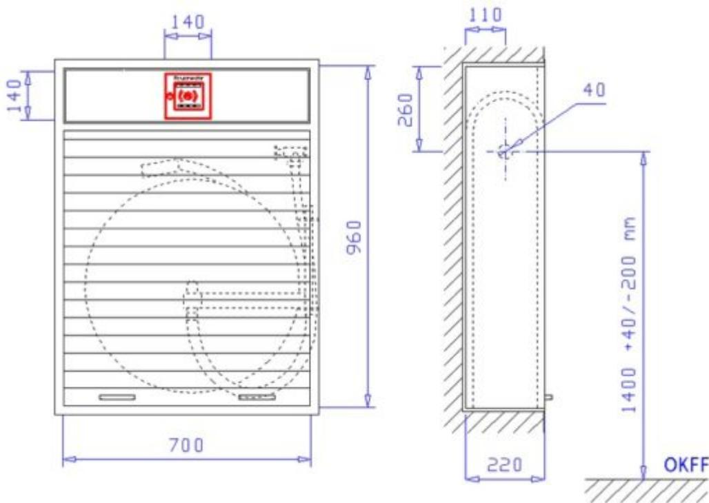
Selbsthilfe-Wandhydrant mit formstabilem Schlauch S-WES-mF-II-S-Ro-220
